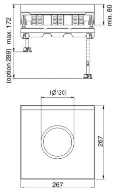
Встроенная рамка + крышка под плитку + водонепроницаемый вывод кабеля + дюралюминиевая рамка + ключ для крышки
