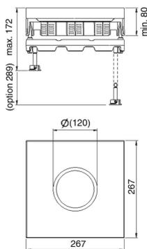
Встроенная рамка + крышка под плитку + водонепроницаемый вывод кабеля + дюралюминиевая рамка + ключ для крышки
