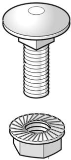
Винт с квадратной шейкой и гайка с зубчатыми насечками (DIN 603)
