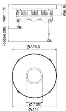
Cadre encastrable + cadre de carrelage + passage de câbles étanche + cadre en alu+ clé pour couvercle de tube
