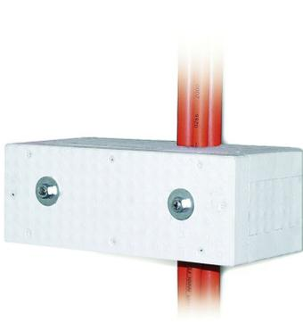
Soutien efficace pour installation verticale à utiliser à des intervalles jusqu'à 3,5m avec DR15.30 rail et attaches HDH1. Une installation de câble en forme de méandre n'est pas nécessaire.
