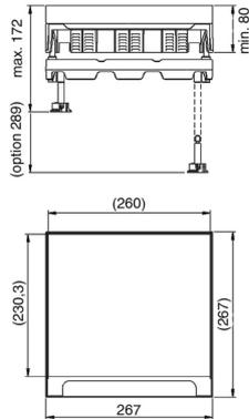
Einbaurahmen + Klappdeckel + Kabelauslass aus Edelstahl + Alurahmen
