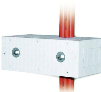
Wirksame Unterstützungs-Maßnahme bei vertikaler Verlegung, Abstand bis zum 3,5 m über die Kabelverlegung mit DR15.30 rail und Kabelklemme HDH1. Eine mäanderförmige Kabelverlegung entfällt bei Einsatz der WUM. Entspricht der Norm DIN4102-12 Funktionserhalt.
